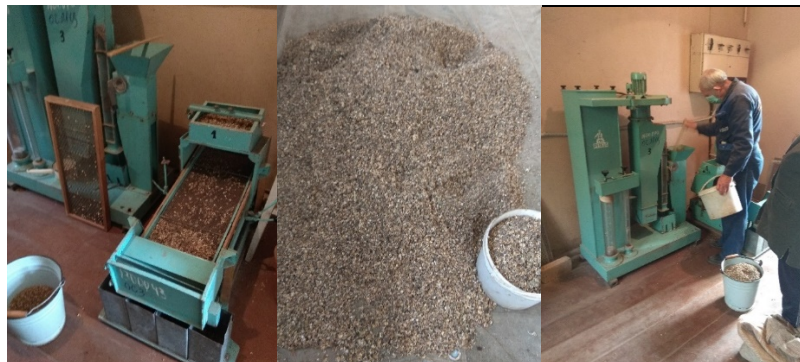
Рисунок 4.3.6 - Сортировка семян на лабораторном комплексе
